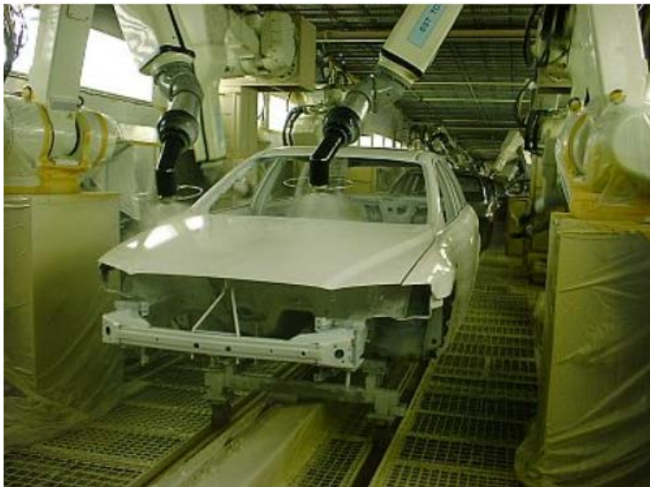
Rys. 4. Roboty Kawasaki na linii malowania wstępnego w szanghajskiej firmie Automotive
