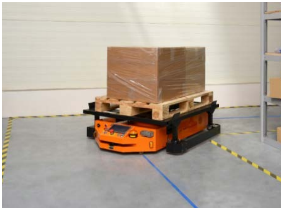
Rys. 1. Wózek WObit z paletą przemysłową 1200 x 800 w czasie pracy
