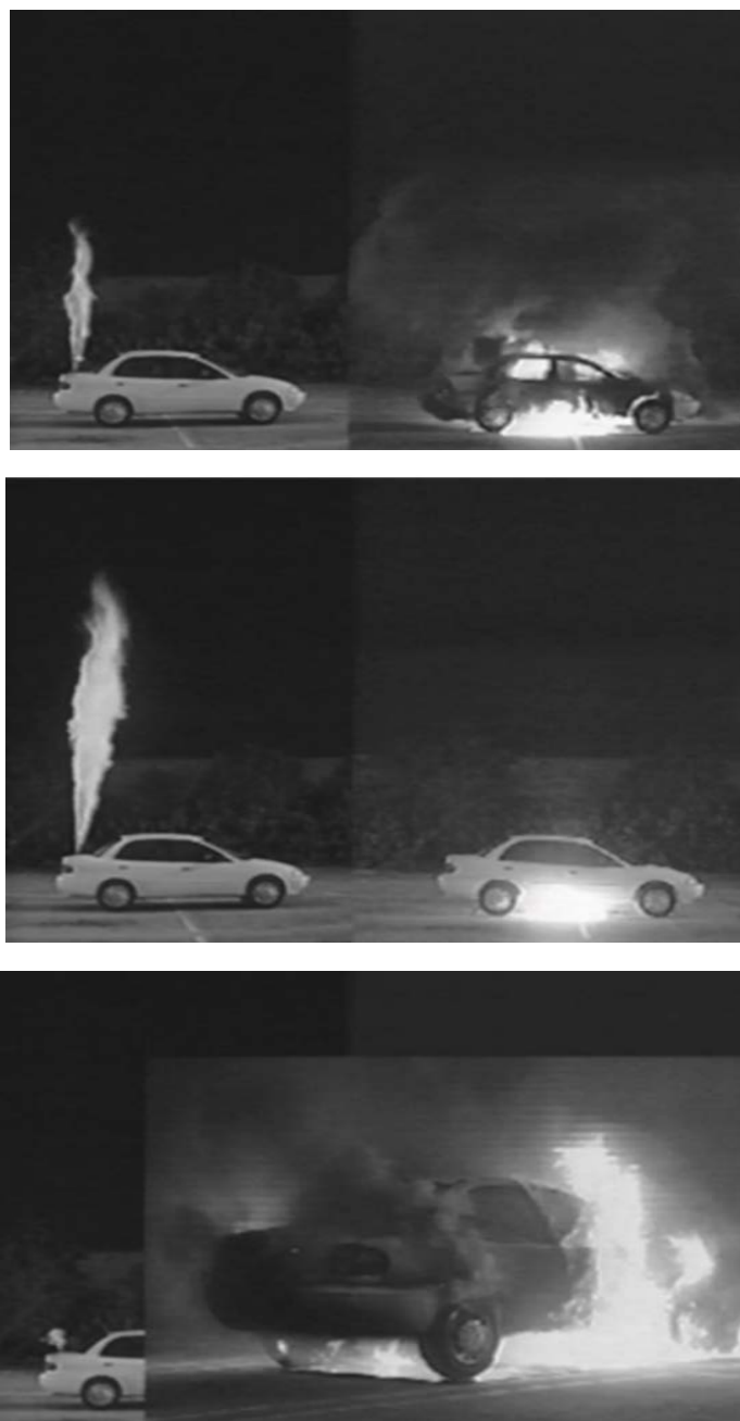
Rys. 3. Skutki wycieku i zapłonu paliwa
